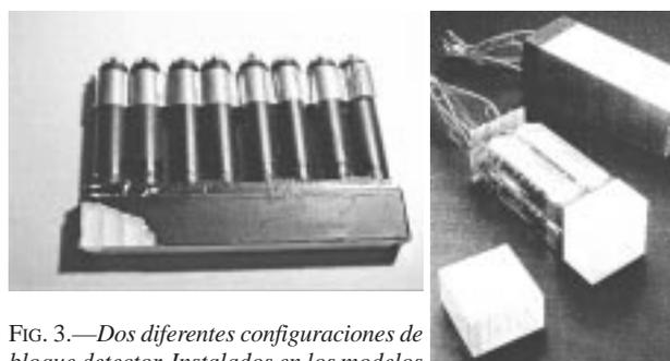
FIG. 3.—Dos diferentes configuraciones de bloque detector. Instalados en los modelos Posicam HZL (Positron Co.) con matriz de BGO de 16 x 2 cristales (arriba) y ECAT EXACT 47 (CTI / Siemens) con matriz de 8 x 8 cristales (derecha).
